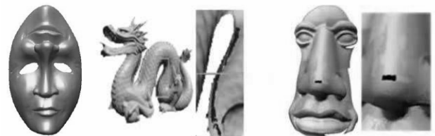
Figura 3. a) Hueco de la superficie, b) Hueco generado por oclusión y escaneo parcial
